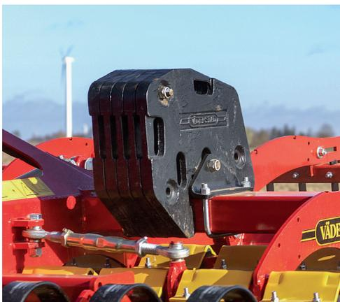
Carrier 400 se puede equipar con paquetes de pesos dando como resultado hasta 800kg/m.
