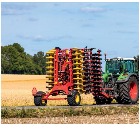
Para transportar el Carrier XL 425-725, la máquina pliega las alas para ajustarse dentro de un ancho de transporte de 3 m.
